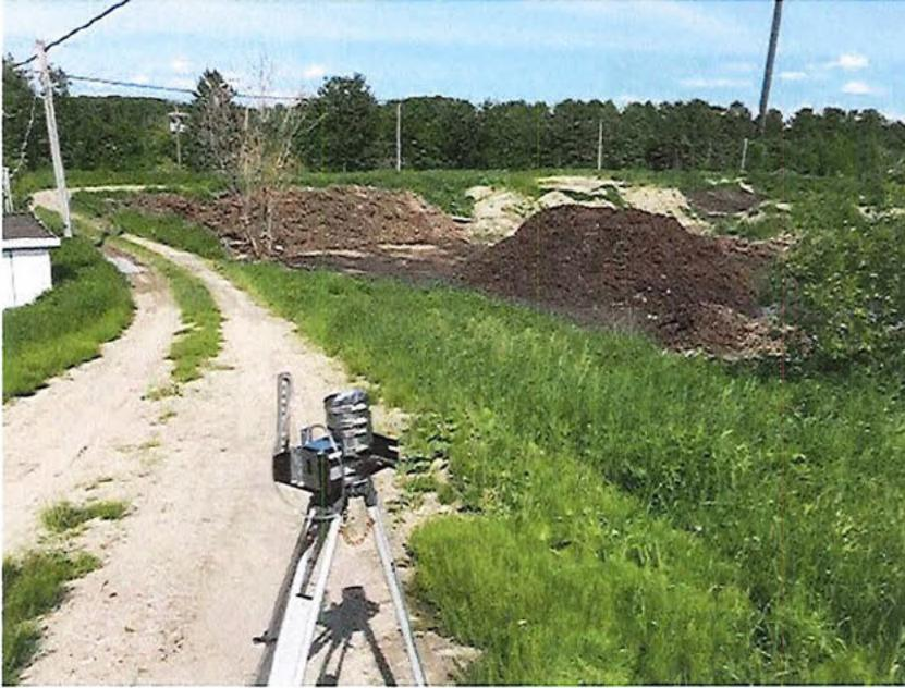
Photo 3 : Échantillonnage d'aldéhydes et de cétones au point 3 sur le site de Gazon Savard Inc.
