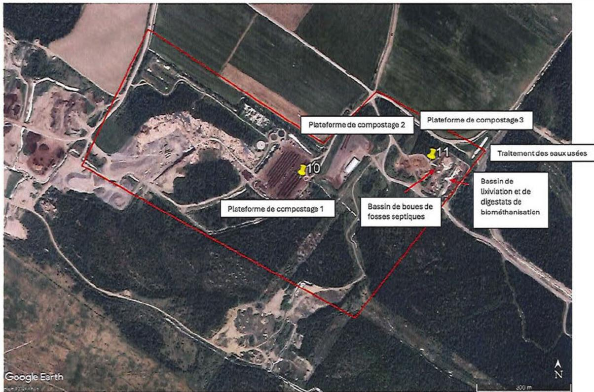
Figure 2 : Points de mesure et d'échantillonnage sur le site de Gazon Savard
